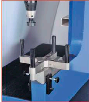
Torreta para insertar hasta 4 fijaciones sin soltar la pieza de la mano.
