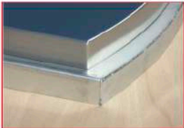
Ejemplos de piezas desbarbadas y pulidas.
