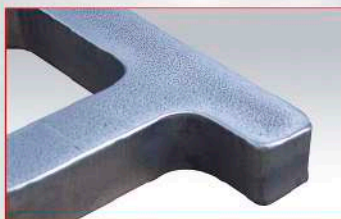
Ejemplo de eliminación de óxido y redondeo de aristas
